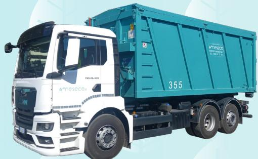
**Motrice Scarrabile 3 ASSI "tipo MAN":****Cassone da 30 mc Chiuso con Coperchio Idraulico**
